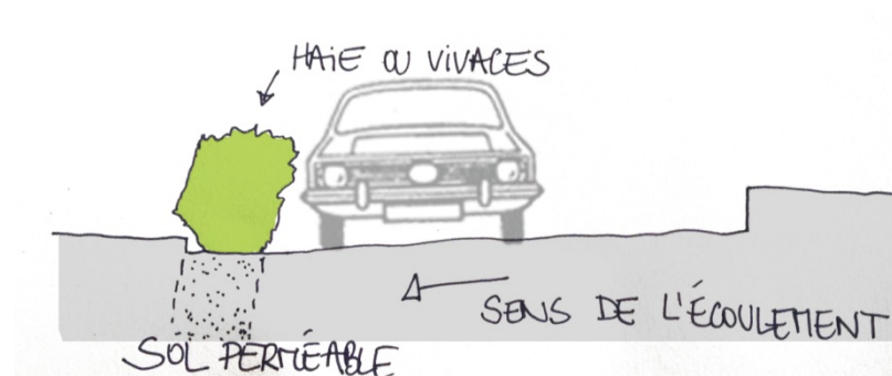
Schéma de principes de récupération des eaux pluviales
